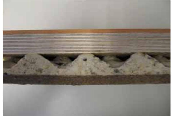
Bild 27: Aufbau eines typischen flächenelastischen Sportbodens
