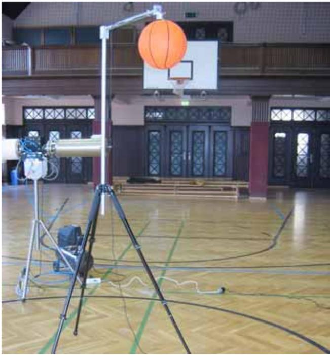
Bild 30: Messung der Ballreflexion
